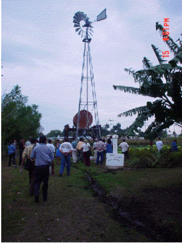
Fig 11: En una visita a un huerto escolar donde se utiliza energía eólica para elevar el agua que asegura el riego de las plantas.
